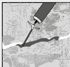
Заполнение трещин и пустот;
